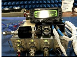
La frequenza di downlink è di 437,800 MHz. Le operazioni di trasmissione avvengono in modo cross band FM utilizzando la frequenza di uplink di 145,990 MHz., con un tono di accesso sub audio [CTCSS] di 67 Hz. Il sistema è costantemente attivo (viene interrotto durante le operazioni EVA degli astronauti) e il suo funzionamento viene descritto nelle [pagine del sito dell' AMSAT](#).
