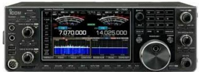
La Sezione, alcuni mesi fa, ha acquistato una nuova radio, l'**ICOM 7610**. È un ricetrasmittitore HF - 50 MHz di elevate prestazioni con due ricevitori a campionamento RF diretto e filtri preselettori indipendenti per le due sezioni.
