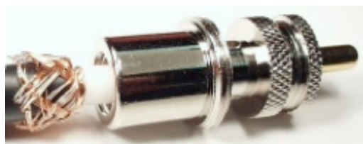
Foto 6 - inserimento corpo connettore forzandolo ed avvitandolo con l'aiuto di una pinza, fino a far scomparire la calza nel corpo e far toccare il dielettrico nel fondo
