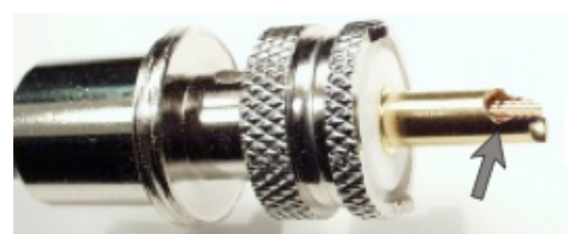
Foto 7 - saldare il centrale assicurandosi che lo stagno sia di ottima qualità e ben fuso - togliere l'eventuale eccedenza di stagno con un cutter e tagliare l'eventuale eccedenza del centrale
