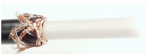
Foto 4 - ripiegamento della calza all'indietro, meglio se "pettinata" - in caso di RT 50/20 togliere la foglia di rame
