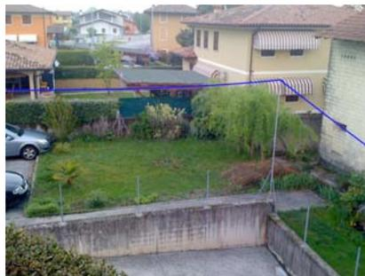
Detto e fatto. Ho iniziato a stendere del filo da impianti elettrici da 1,5 mm<sup>2</sup> dalla presa del balun fino al sottotetto e poi giù fino ad una carrucolina di rinvio attaccata ad un palo per antenne tv a circa 5 metri da terra, fissato all'angolo dello scivolo e da lì poi, fino ad una palina della rete di recinzione dietro i garage tramite un cordino di nylon.
